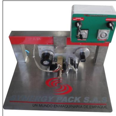
El codificador con transferencia térmica es electrónico, con numeración de 0 a 9, logos de lote y vencimiento con una altura de letras de 3mm , para codificar sobre celofán, PVDC prolipopileno, poliester, polietileno y cualquier tipo de material termosoldable, con un rango marcación hasta de 2 líneas
